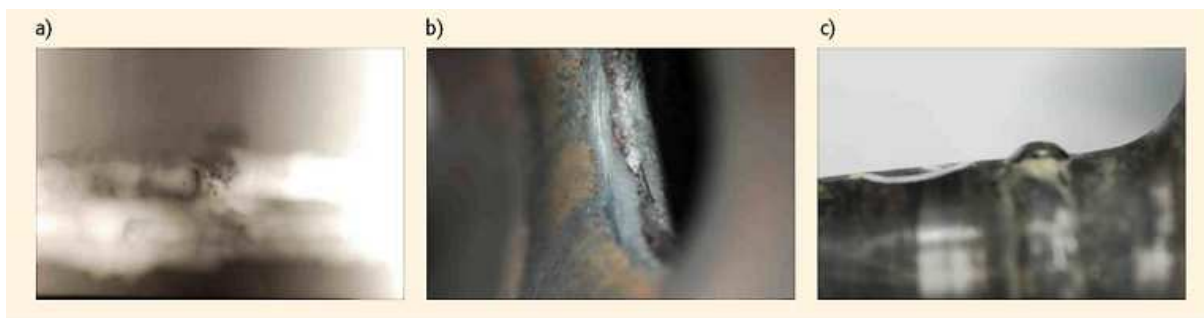
Rysunek 5. Przykłady niezgodności; a) (2011, 517) gniazdo pęcherzy, niewłaściwe ponowne rozpoczęcie spawania; b) (402) brak przetopu; c) (502) nadlew spoiny
